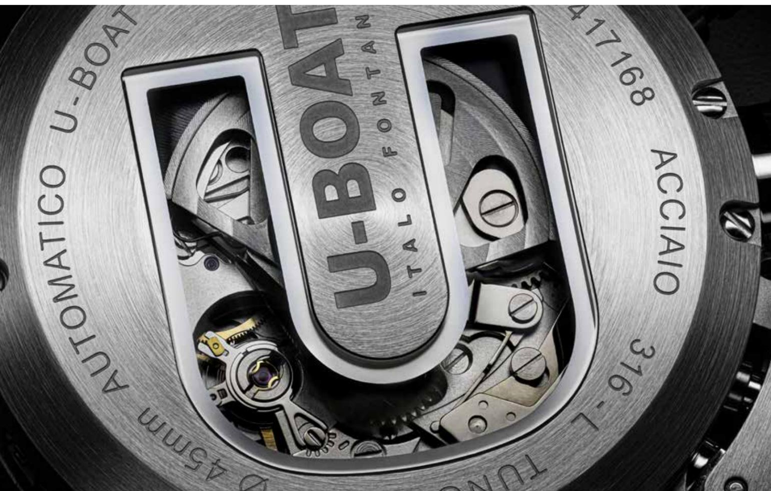
com *layout* 6-9-12, baseado na popular estrutura do ETA/Valjoux 7750 e chamado de "clone ETA". Possui 30 mm de diâmetro e 7,9 mm de espessura, rotor esqueletizado, trabalha com uma frequência de 28.800 alternâncias por hora (4 Hz) e proporciona uma reserva de corda de aproximadamente 62 horas.
