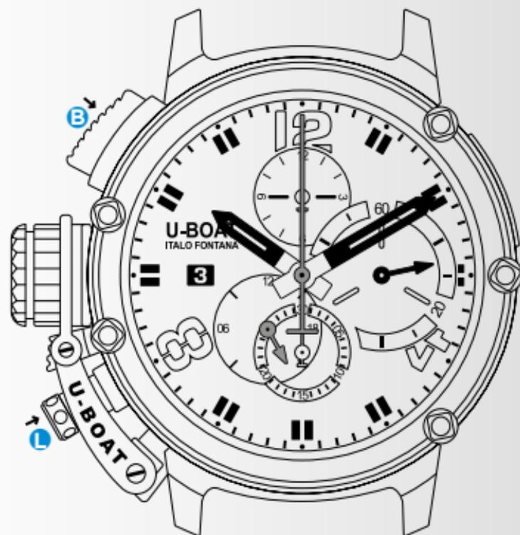
Premere il pulsante **L** (avvio/arresto) per la messa in moto della lancetta del cronografo ed il totalizzatore delle ore/minuti.
